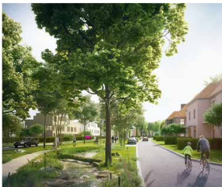
Uliční odvodňovací pás pro hospodaření s dešťovou vodou.
